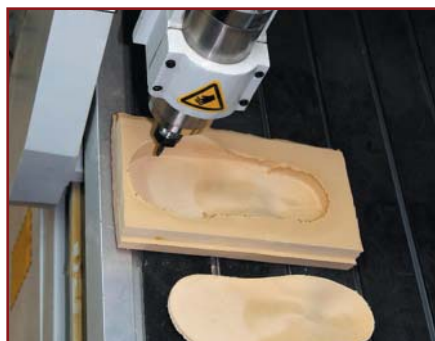
Изготовление индивидуальных ортопедических стелек-супинаторов на станке с ЧПУ
