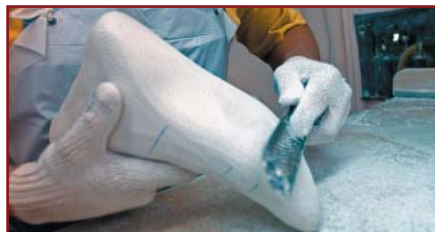
Изготовление индивидуальной гипсовой колодки
